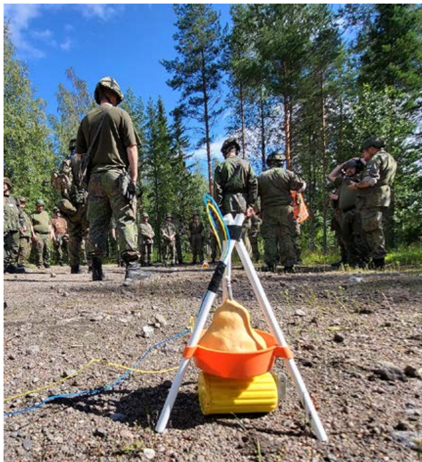
■ Harjoituksessa edettiin harjoitusvälineistä koviin räjähdysaineisiin. Käsikranaatin raivaamisessa apuna toimi kolmijalka, jolla panoksen sai turvallisesti kohteen yläpuolelle.
